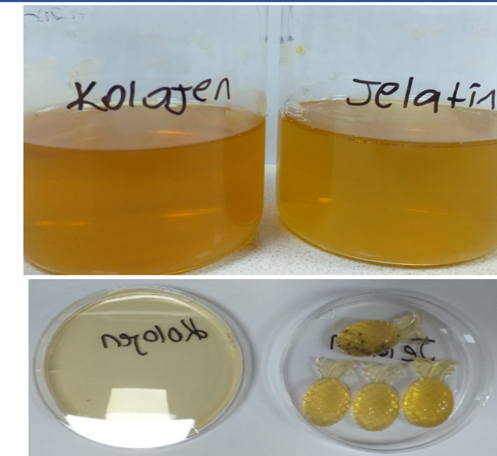
Şekil 4. Kolajen ve jelatin solüsyonları kalıplamadan 1 saat sonra
